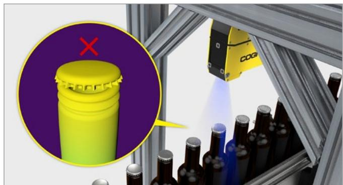
Vérifiez que la bouteille est correctement scellée en contrôlant la hauteur et l'angle d'inclinaison du bouchon.
