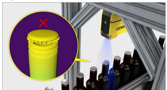
Stellt durch Kontrolle der Höhe und des Neigungswinkels des Flaschenverschlusses sicher, dass die Flasche ordnungsgemäß versiegelt ist.
