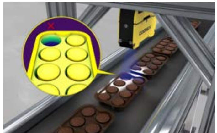
Erfassen fehlender Objekte in Kartons durch Messung der Höhe
